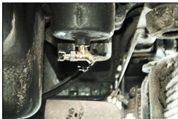
Рис. 1. Пробоотборник установленный в стакан масляного фильтра
