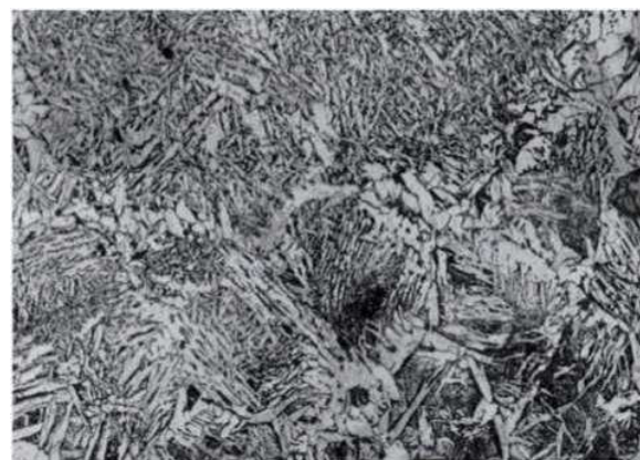
Рисунок 7 – Микроструктура зоны сплавления стыкового сварного соединения из стали Ст30МnB5 толщиной 3 мм, \times 100
