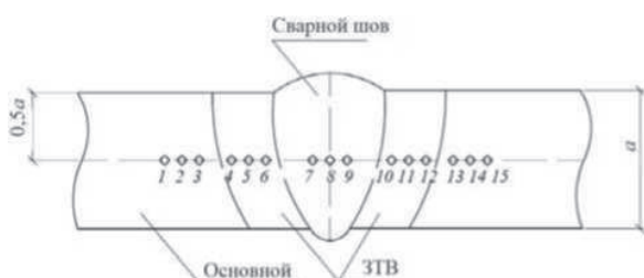
Рисунок 11 – Изменение микротвердости в различных зонах стыкового сварного соединения из стали Ст30МнВ5 толщиной 3 мм
